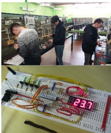
**Realizzazione e progettazione impianti Elettrici ed Elettronici.** Utilizzando componenti elettrici ed elettronici con il supporto dei docenti, partendo da uno schema elettrico, si realizzeranno un impianto elettrico e un impianto elettronico. Si potrà azionare un comando luce temporizzato e controllato con il crepuscolare, si potrà attivare un comando di un impianto di automazione industriale e si potrà realizzare una piccola breadboard elettronica.
